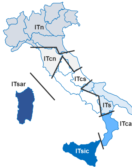
Figura 1 - Struttura zonale della RTN.
