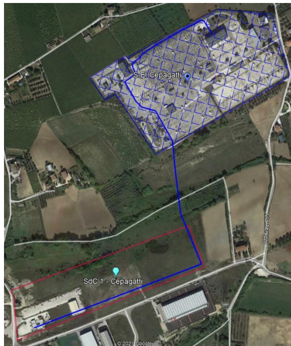
Figura 21: Collegamento AC da SdC a SE Cepagatti
